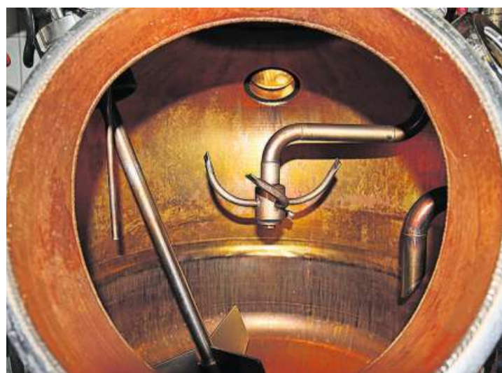
Das Innere des Brennhafens: Auf dem Griff wird der Korb befestigt, in welchem sich die Botanicals für den Corvus-Gin befinden.
